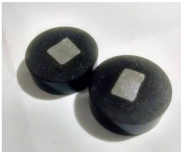
Figura 3 - corpos de prova com todos os processos realizados. (à esquerda o CP com ataque químico e à direita o CP apenas com polimento. Fonte: O autor.
