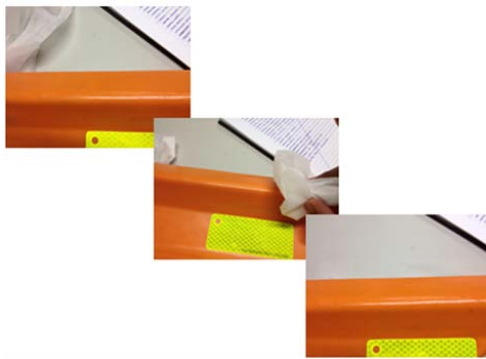
Figura 5. Limpeza de cobertura de conduto confeccionada em polietileno. Neste material nota-se que manchas e marcas enegrecidas foram limpas durante o processo.
