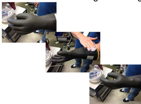
Figura 4. Limpeza de luva isolante confeccionada em material elastomérico. Neste material nota-se que manchas e marcas brancas foram limpas durante o processo.
