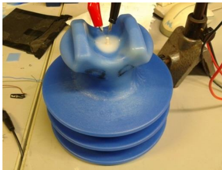
Figura 14: Isolador polimérico com fonte de temperatura constante ao centro.
